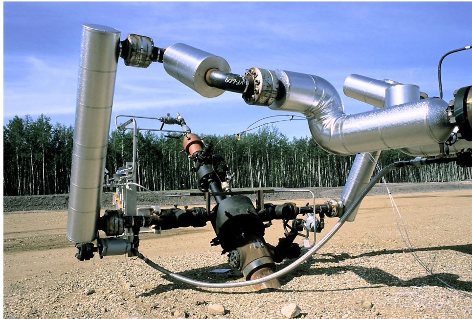
Abbildung 32: SAGD: Horizontale Sonde (Einförderung von Dampf)
